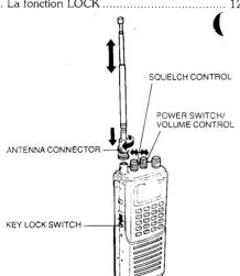
Installez l'antenne fournie (ou tout autre antenne compatible) sur l'embase et tournez son connecteur BNC d'un angle de 45° vers la droite nour le vérouiller.
