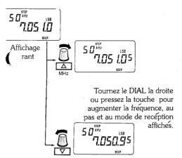
Tournez le DIAL vers la gauche ou pressez la touche pour diminuer la frequence dans les mêmes conditions. • Tout signal occupe une largeur de bande appelée "largeur de bande occupée" plus ou moins importante selon son type de modulation. Un signal dont largeur de bande est inférieure a la band passante du récepteur peut ne pas être reçu correctement au point le plus fort. Ceci est du à la valeur du pas d'incrément (résolution).
